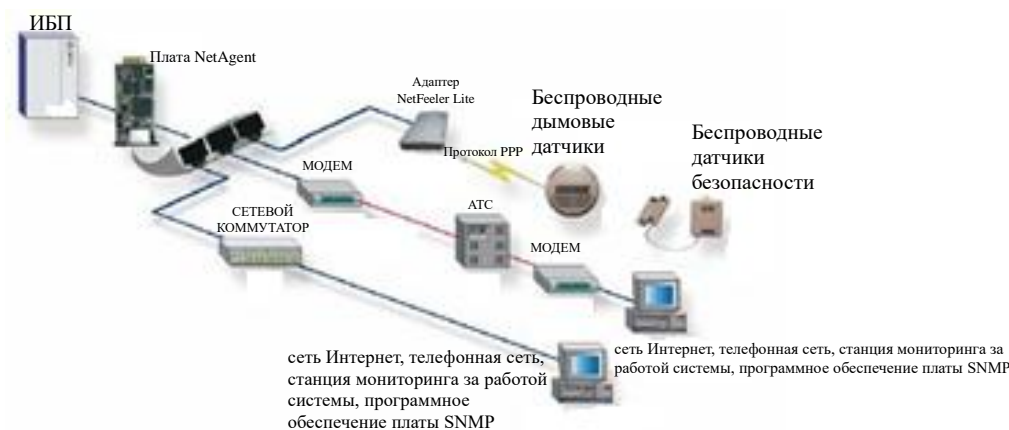
Стандартная топология сетевого управления ИБП
